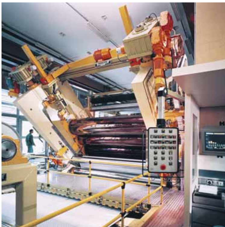
Расплавленный каландр: Термопластическое покрытие экструдировается, каландрируется и натягивается в процессе плавления на ширину до 4200 мм.
